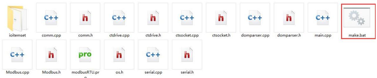
执行make.bat后，文件夹下会生成相应的VS工程文件，下面标注的文件即为vs的工程文件；
